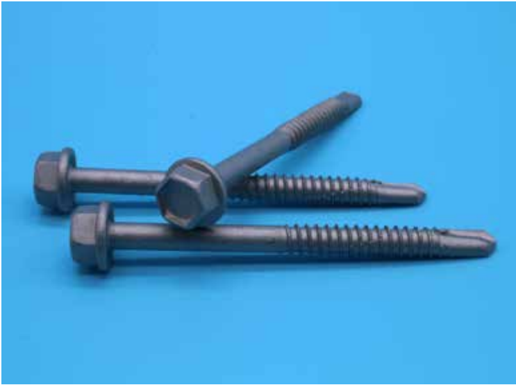
钉入6mmSPCC铁板→拔出后实施性能测试
