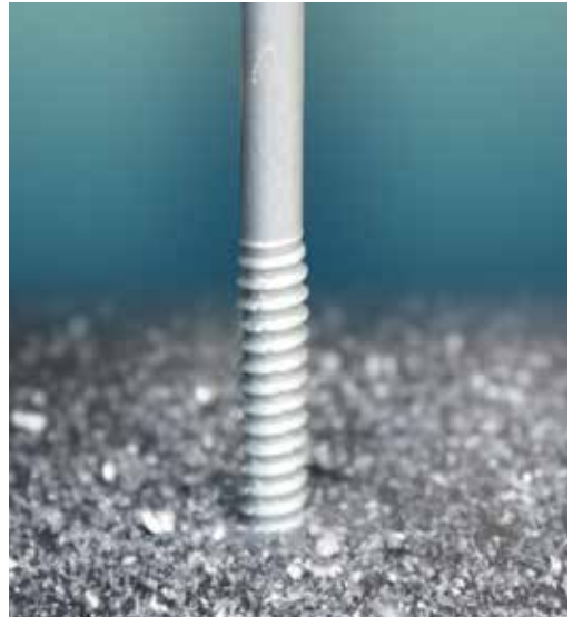
钉入6mmSPCC铁板→拔出后实施性能测试
